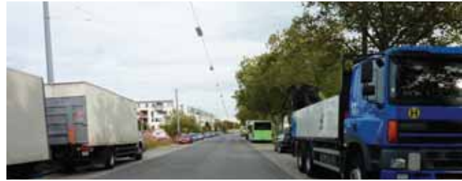
Abb. 6: Typ C und Beispiel: Fahrbahn 2streifig, Längsparken, ohne Straßenbäume, 7 - 17 m
